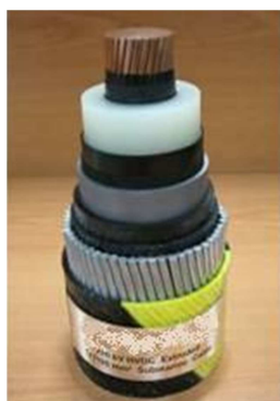
Fig. 13: 1100 mm² Cu +/- 200 kV XLPE cable
