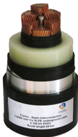
Fig. 15: 2500 mm² Cu +/- 320 kV XLPE cable
