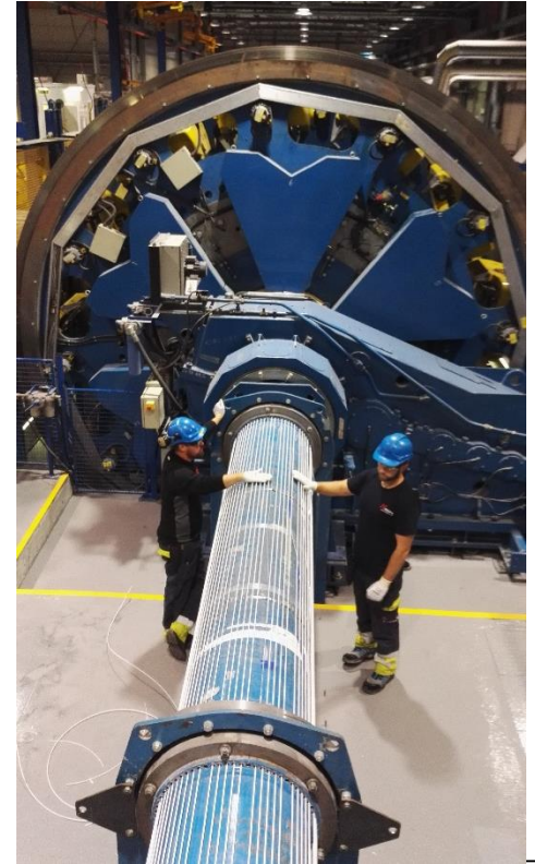
(TKRA 245 kV 3x1x1800 mm 2 AQ + 2xFO)
