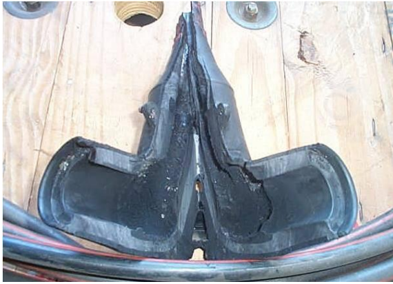
Fotos I e II: Terminal de condutor e transformador submersível danificados por falhas em isolamentos
