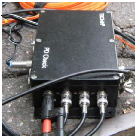
Foto VII e VIII : PDCheck conectado ao notebook permitindo a leitura dos resultados in-loco
