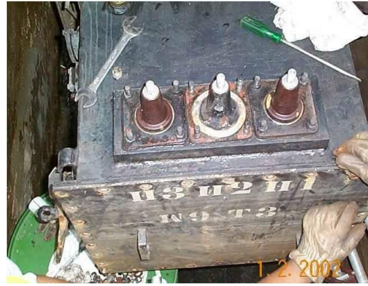
Fotos I e II: Terminal de condutor e transformador submersível danificados por falhas em isolamentos
